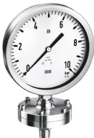
В манометрах серии ММ900 чувствительным элементом является диафрагма с концентрическими гофрами, приводящая в действие усилительный механизм через патрубков. Предназначен для измерения давления, вакуума вязких жидкостей, кристаллизующихся или загрязненных технологических жидкостей. Эти приборы более надежны и их легче защитить от избыточного давления, чем приборы с трубкой Бурдона в соответствии с EN837-3. Может быть изготовлен в соответствии с директивой АТЕХ <span dir=»ltr»
